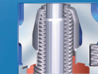
2. Verstärkter Faltenbalg (10.000 Lastspiele) – am Gehäuseoberteil angeschweißt
