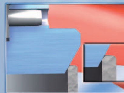
1. „Cut-Effekt“ – durch konischen Kantensitz werden Ablagerungen vom Sitz „geschnitten“
