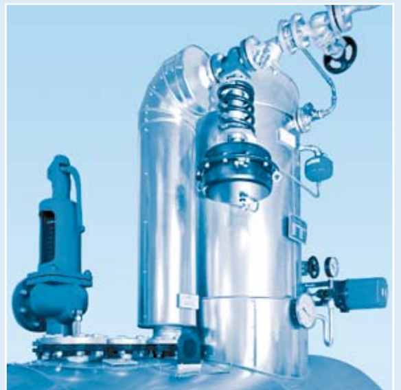
z.B. Speisewasserbehälter mit Entgaserdom... ... für die Zuführung von rückgeleitetem Kondensat und Frischwasser über den Entgaserdom und den Speisewasserbehälter an den Kessel. Langlebigkeit des Kessels durch Abspaltung inerte Gase aus dem Kondensat/Frischwasser.
