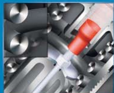
5. Zuverlässig auch bei hohen Differenzdrücken durch drei unterschiedliche Federstärken serienmäßig.
